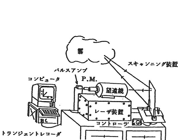
Fig. 3 試作したスキャンニング・レーザ・レーダの概要 (一戸局)
