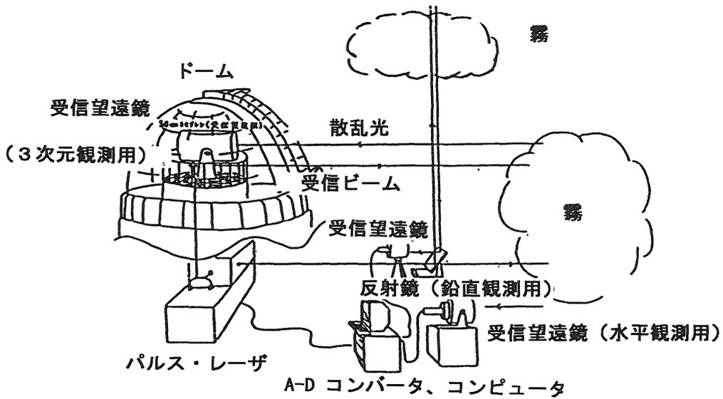
Fig. 2 試作したレーザ・レーダ装置のブロック図 (八戸局)
