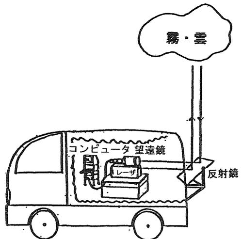
Fig. 4 試作した移動観測車の概要 (移動局)
